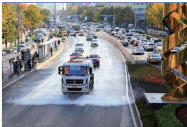
道路冲刷车作业
