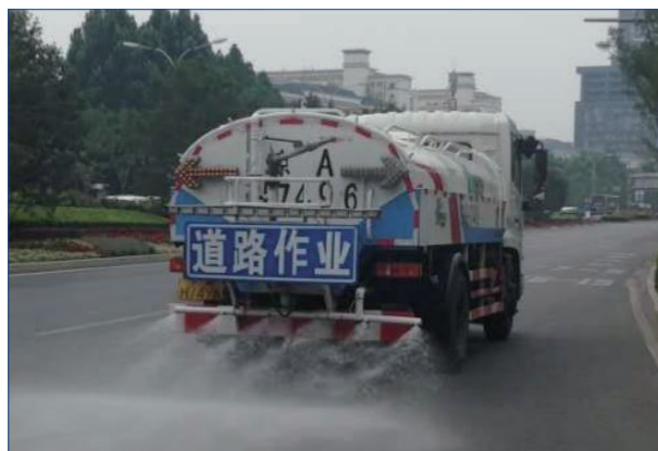
道路降尘车作业
